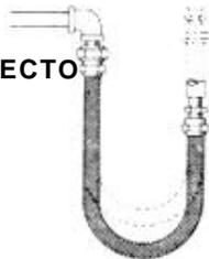
Esta es la manera correcta de instalar una manguera metálica para traslación vertical. Nótese el lazo natural simple.
