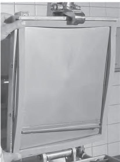
4. Setzen Sie die Dichtung mit der „guten“ Seite nach außen ein und ziehen Sie die 4 Schrauben fest.
