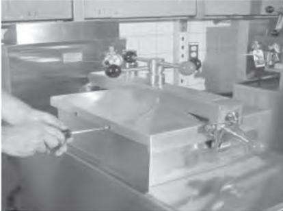
Das Umdrehen der Deckeldichtung dient dazu, ein frühzeitiges Versagen der Deckeldichtung und einen Druckverlust während eines Frittiervorgangs zu verhindern.
