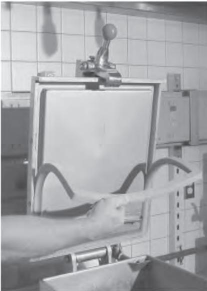
2. Benutzen Sie einen schmalen Schlitzschraubenzieher, um die Dichtung an den Rändern herauszuhebeln. Ziehen Sie dann die Dichtung vom Deckel ab.
