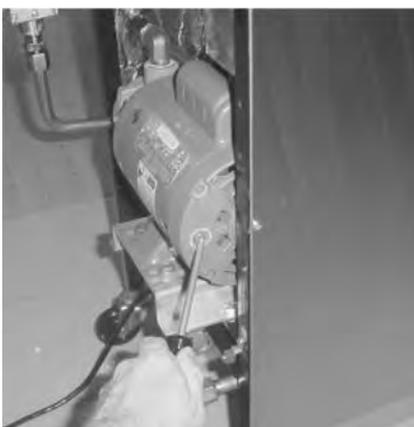
Der Filterpumpenmotor ist an der Motorrückseite mit einer manuellen Rücksetztaste ausgestattet, für den Fall dass sich der Motor überhitzen sollte. 5 Minuten warten, damit sich der Motor abkühlen kann, bevor versucht wird diese Schutzvorrichtung zurückzusetzen. Der Filtermotor befindet sich an der Rückseite der Frittiermaschine. Die Rücksetztaste muss fest gedrückt werden; zur Erleichterung kann dazu auch ein Schraubendreher verwendet werden.
