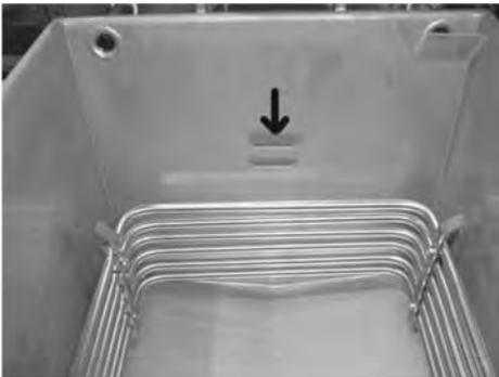
2. Das elektrische Modell 500 erfordert 48 Pfund (21,8 kg) flüssiges Fett; das Modell 561 erfordert 65 Pfund (29,5 kg). Das Gasmodell erfordert 43 Pfund (19,5 kg). Das Frittiermaschinenmodell 500 hat zwei Füllstandslinien an der Rückseite der Frittierwanne; Modelle 561 und 600 haben nur eine Füllstandslinie. Die Füllstandslinien zeigen den korrekten Fettfüllstand.
