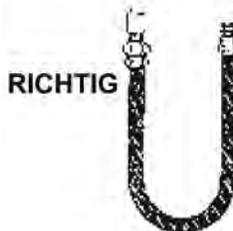
Zwischen den Verbindungsstücken mindestens den minimalen Biegedurchmesser vorsehen, um die Lebensdauer zu verlängern. Wenn der Kreisbogen wie rechts gezeigt an den Verbindungsstücken geschlossen wird, entsteht eine Doppelbiegung, die Werkstoffermüdung an den Anschlüssen verursacht.
