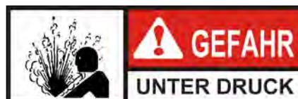
**DEN GRIFF NICHT NACH OBEN ZIEHEN UND NICHT VERSUCHEN DIE DECKELVERRIEGELUNG MIT GEWALT ZU ÖFFNEN, BEVOR AUF DEM MANOMETER 0 PSI ANGEZEIGT WIRD. AUSTRETENDER DAMPF UND AUSTRETENDES FETT VERURSACHT SCHWERE VERBRENNUNGEN.**
