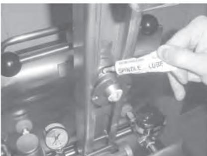
Um die Lebensdauer der Deckelkomponenten zu verlängern, fetten Sie den Kugelsitz und die Spindel entsprechend den folgenden Schritten ein.
