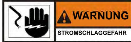
Diese Frittiermaschine muss ordnungsgemäß und sicher geerdet werden, um Stromschlaggefahr zu vermeiden. Informationen für die korrekten Erdungsverfahren finde Sie in den örtlichen Elektrovorschriften oder falls solche örtlichen Elektrovorschriften nicht existieren in 'The National Electrical Code, ANSI/NFPA No. 70' (die aktuell gültige Version). In Kanada müssen alle Elektroanschlüsse gemäß CSA C22.1 Canadian Electrical Code Part 1, und/oder den örtlichen Vorschriften ausgeführt werden.
