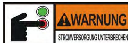
Um durch spritzendes Öl verursachte Verbrennungen zu vermeiden, muss der Netzschalter des Geräts auf AUS gestellt werden, bevor die manuelle Rücksetzschutzeinrichtung des Filterpumpenmotors zurückgesetzt wird.
