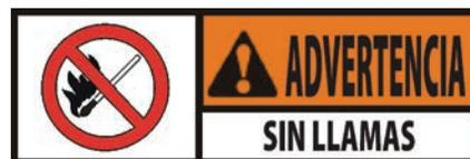
**Para evitar incendios o explosiones, no utilice nunca cerillas encendidas ni llamas para verificar que no haya fugas de gas. Si el gas se inflama, se podrían generar lesiones físicas graves o daños materiales.**
