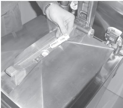
3. Con el lubricante para el eje (pieza n.º 12124), lubrique el cojinete de bolas en el centro de la cubierta de la tapa.
