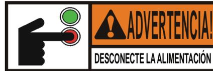
**Para evitar quemaduras producidas por salpicaduras de manteca vegetal, ponga el interruptor de alimentación principal en OFF antes de reiniciar el dispositivo de protección con reinicio manual del motor de la bomba del sistema de filtrado.**
