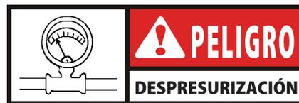
**NO LEVANTE LA MANIVELA NI FUERCE EL PESTILLO DE LA TAPA PARA ABRIRLA ANTES DE QUE MANÓMETRO INDIQUE "0" LB/PULG.<sup>2</sup>. LA SALIDA DE VAPOR Y MANTECA VEGETAL PROVOCARÁ QUEMADURAS GRAVES.**
