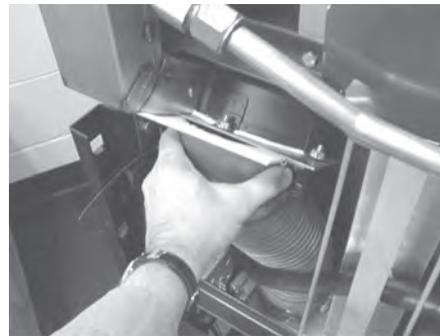
4. 使用刷子或一字螺絲刀清潔風機的各翼。確保各翼清潔，無雜物。
