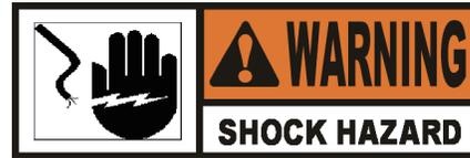
若要避免觸電，請勿斷開接地插頭。炸鍋必須完全並安全的接地。請參閱本地的電氣法規以獲取正確接地程序，若無本地法規，則請參閱國家電氣法規，**ANSI/NFPA 第 70 號**（目前版本）。在加拿大，所有電氣連接皆必須遵循 **CSA C22.1**，加拿大電氣法規第 1 節，和/或本地法規。
