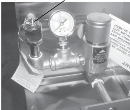
2. Svitare il galletto situato sul pannello di accesso inferiore sinistro, sulla parte posteriore della friggitrice, e togliere il pannello stesso. Pulire la cartuccia di diluizione con un panno o una spazzola. Verificare che i fori della cartuccia non siano ostruiti. Al termine, rimettere il pannello.
