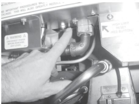
Un dispositivo di sicurezza che rileva la temperatura del grasso; se questa supera 216 °C, il termostato si apre e disinserisce il sistema di riscaldamento della vasca. Quando la temperatura del grasso scende a un limite operativo di sicurezza, occorre ripristinare manualmente il termostato premendo l'apposito pulsante rosso situato sotto il pannello di controllo, sul lato anteriore destro della friggitrice.
