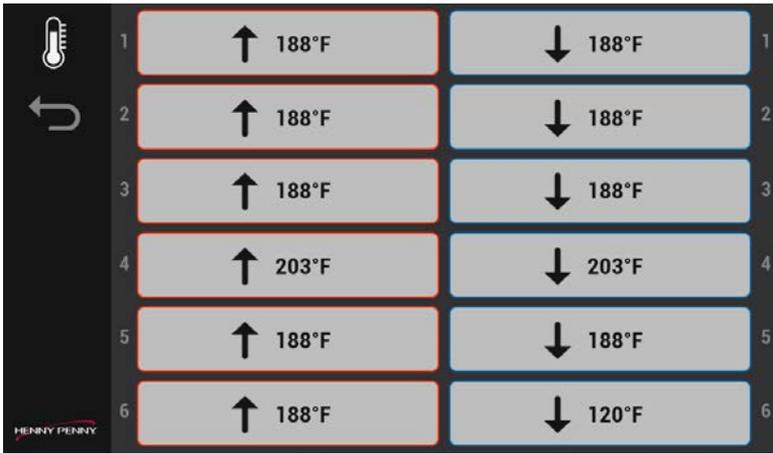
1. 在主菜单屏幕中，点击搁架(行)温度图标。将显示搁架的当前温度。
