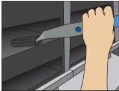
6. 使用带垫的高温多用途工具擦洗每个 UHC 机柜搁架内部。
