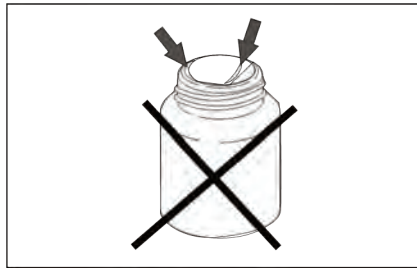
Pellicule de cire endommagée sur la cartouche
