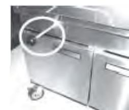
3、按下 按鈕選擇是，顯示器顯示“OPEN DRAIN（打開泄油閥）”。拉出泄油閥旋鈕，顯示器顯示“DRAINING（泄油）”，食油從炸缸中排出。
