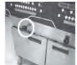
5、一旦炸缸注滿，顯示器可能顯示“IS POT FILLED?（炸缸是否注滿？）”“YES NO（是否）”。確保炸缸已注滿，然後按下 按鈕選擇是，炸鍋返回正常運行。如果炸缸尚未注滿，按下 按鈕選擇否，再次泵送食油30秒。
