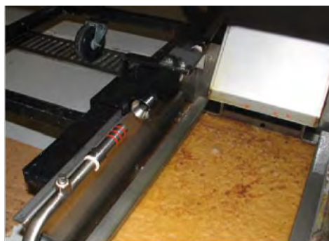
Obrázok 3-26 Zarovnanie trubice filtra a armatúry
