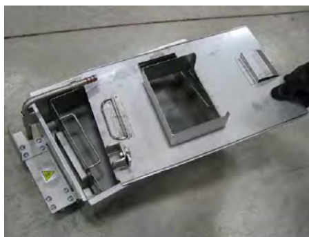
Obrázok 3-20 Demontáž veka vypúšťacej nádoby
