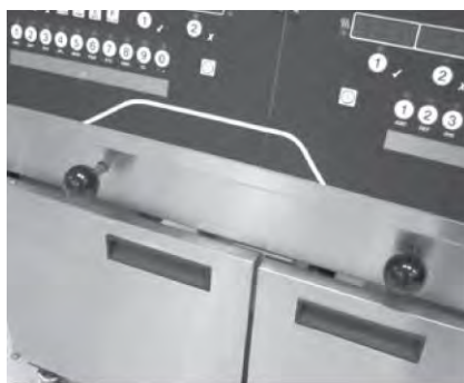
Obrázok 3-11 Vypúšťacie tlačidlo zatvorené
