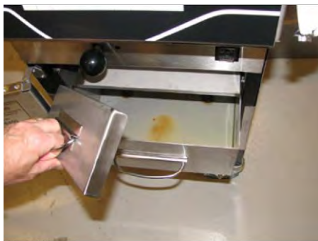
Obrázok 3-5 Demontáž veka zásobníka
