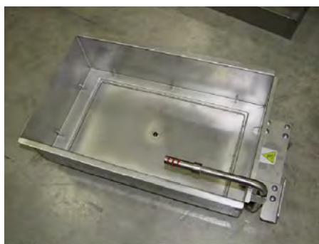
Obrázok 3-25 Vyčistenie vypúšťacej nádoby
