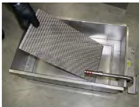
Obrázok 3-24 Odstránenie spodného sitka
