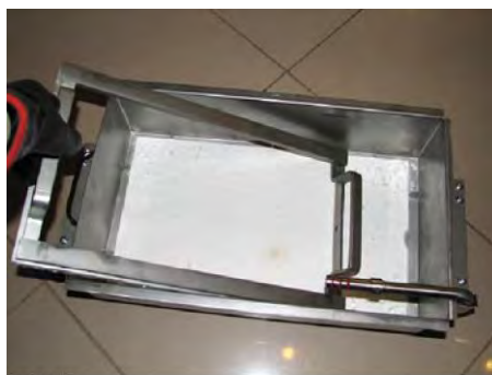
Obrázok 3-22 Demontáž poistného krúžku filtračnej podložky
