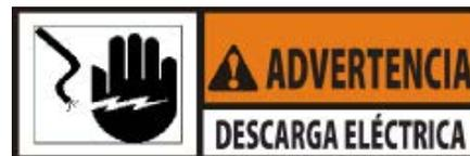
**Para evitar descargas eléctricas, este aparato debe estar equipado con un interruptor automático externo que incorpore una desconexión de 3 mm en todos los conductores sin conexión a tierra. El interruptor principal de alimentación de este aparato no desconecta todos los conductores de línea.**
