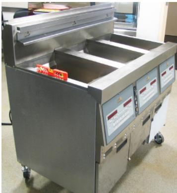
Para un funcionamiento adecuado, la freidora abierta debe estar nivelada de lado a lado y de atrás a delante. Coloque un nivel de burbuja en las superficies planas alrededor de la cubeta, en la cavidad central, y a continuación regule las ruedas giratorias hasta que la unidad quede nivelada.
