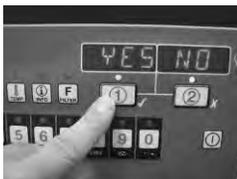
**Vasca piena d'olio:** Premere il tasto X; sul display compare "IS DISPOSAL UNIT IN PLACE?" (per le friggitrici con contenitore dell'olio monouso [JIB]) o "CHK PAN" (per le friggitrici con contenitore dell'olio rabboccabile) insieme a "YES NO".
