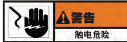
此油炸机必须充分安全接地，否则会导致触电。关于正确接地程序，参见当地电气规范，如果当地规范没有做要求，则应符合电气规范ANSI/NFPA No. 70-（现行版）。在加拿大境内的所有电气连接必须符合CSA C22.1《加拿大电气规范》第1部分和/或当地规范的要求。
