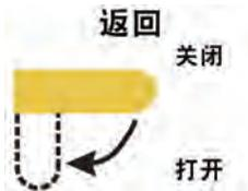
表示转动黄色手柄的方向以打开加油阀向炸桶加油
