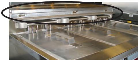
应当定期撤洗油炸机后外板上的炸篮靠架。
