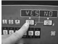
**Tanques de una pieza:** Pulse el botón y la pantalla mostrará "OIL RMVD" (eliminación de aceite) junto con "YES NO" (sí no)
