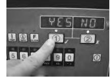
**Tanque lleno de aceite:** Pulse el botón X y la pantalla mostrará "IS DISPOSAL UNIT IN PLACE?" (¿la unidad de eliminación está en posición?) junto con "YES NO" (sí no) para los sistemas JIB o "CHK PAN" (comprobación de bandeja) para los sistemas de volumen de aceite.
