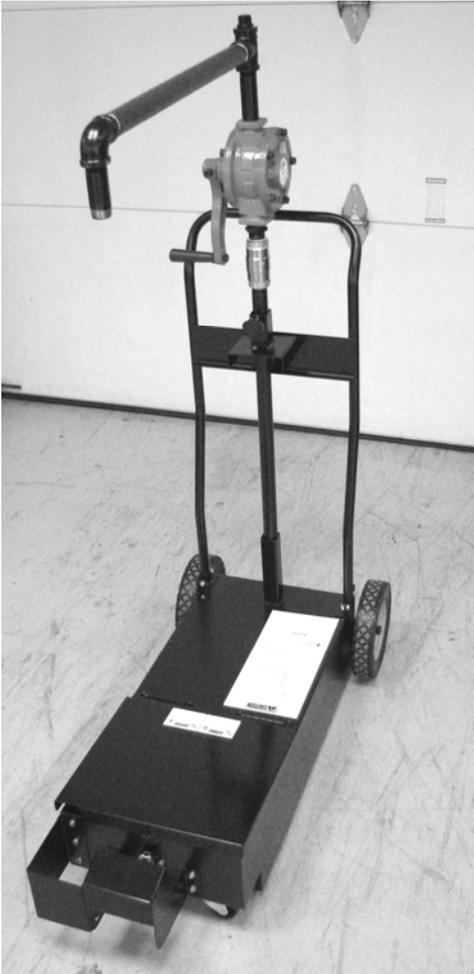
14. Una vez que el carrito esté vacío, afloje el tornillo del soporte y haga girar el conjunto de bomba hacia atrás sobre la unidad inferior y apriete la palanca.
