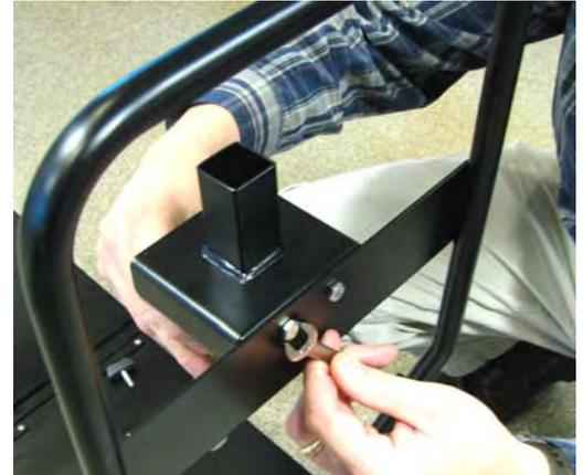
SUJETE EL SOPORTE A LA PALANCA CON LOS PERNOS INCLUIDOS Y DESLICE EL CONJUNTO DE BOMBA Y TUBO POR LOS TUBOS CUADRADOS INTRODUCIÉNDOLO EN EL TUBO REDONDEADO.
