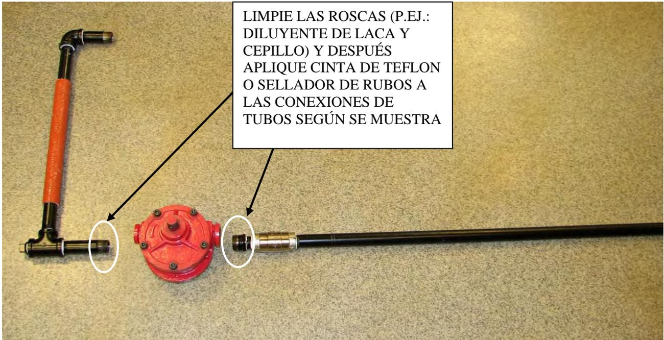
LIMPIE LAS ROSCAS (P.EJ.: DILUYENTE DE LACA Y CEPILLO) Y DESPUÉS APLIQUE CINTA DE TEFLON O SELLADOR DE RUBOS A LAS CONEXIONES DE TUBOS SEGÚN SE MUESTRA
