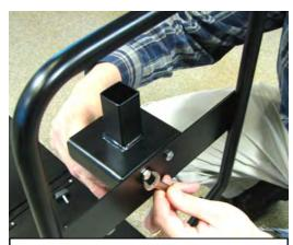
FISSARE LA STAFFA AL MANICO CON LE VITI FORNITE E FARE SCORRERE IL GRUPPO POMPA-TUBO NEL TUBO QUADRATO E NEL TUBO CILINDRICO.
