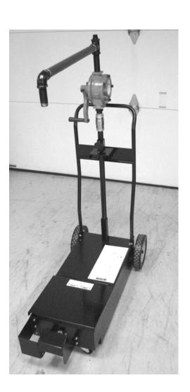
13. Ruotare il manico della pompa per adescarla e fare fluire l'olio attraverso la pompa stessa.
