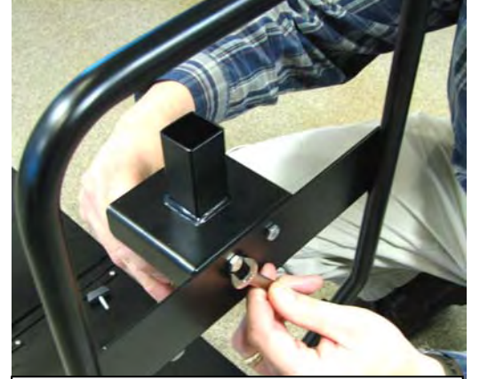
ثبت الكتيفة بالمقبض باستعمال البراغي (مسامير القلاووظ) المزودة. ومن ثم قم بزلق مجموعة المضخة والأنبوب عبر الأنبوب المربع ومن ثم عبر الأنبوب المستدير.
