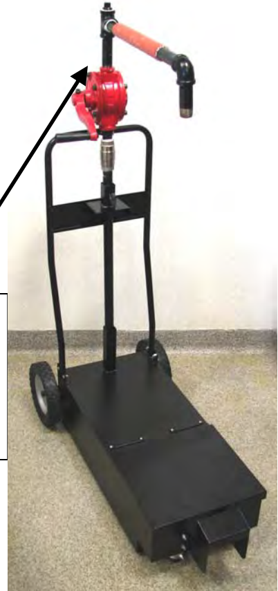
خذ مجموعة الأنابيب السوداء وصلها بأعلى المضخة كما هو مبين باستعمال شريط تيفلون أو مادة كيميائية مانعة للتسرب. أدرها لتثبيتها بإحكام ومراصفتها كما هو مبين أدناه.
