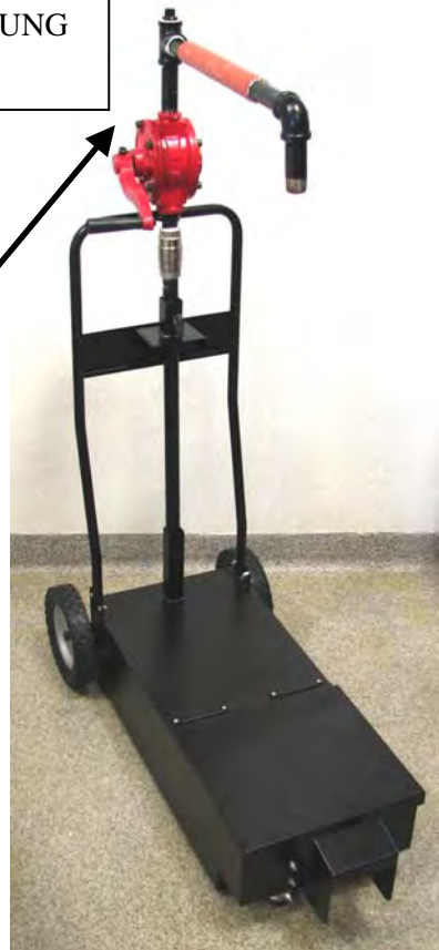
SCHWARZE ROHRLEITUNG WIE ABGEBILDET MIT TEFLONBAND AN DER OBERSEITE DER PUMPE ANBRINGEN. DIE LEITUNG DREHEN, BIS SIE FEST SITZT UND WIE UNTEN ABGEBILDET AUSGERICHTET IST.
