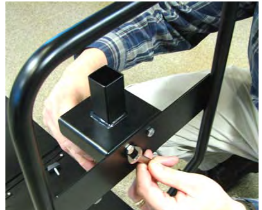
HALTERUNG MIT DEN MITGELIEFERTEN SCHRAUBEN AM GRIF ANSCHRAUBEN UND PUMPE MIT ROHR DURCH DAS QUADRATISCHE ROHR IN DAS RUNDE ROHR SCHIEBEN.
