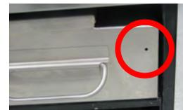
La condensación adicional de la bandeja se drenará al depósito de condensación. El depósito está equipado con un orificio de drenaje que le indicará que el depósito está lleno y que necesita vaciarse.
