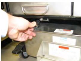
1. Deslice una almohadilla de filtro sobre la malla de filtrado de forma que el tapón sobresalga a través del orificio.
