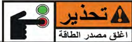
يلزم إيقاف تشغيل زر الطاقة الأساسي للوحدة قبل إعادة ضبط جهاز حماية إعادة الضبط اليدوي لمحرك مضخة المصفاة، وذلك لتجنب تآثر الزيت.
