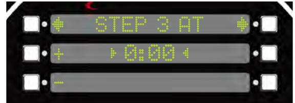
١٤- أدخل ٠:٠٠ في الوقت، وستكون هذه هي النهاية التلقائية لدورة الطهي، واستخدم الزر المجاور للسهم الأيمن للانتقال إلى TEMP 1 (درجة الحرارة ١).
