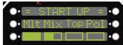
Durante ogni fase, il grafico a barre si riempirà via via che ogni fase si avvicina al completamento. La durata di ogni fase dipende dalla temperatura dell'olio all'avvio iniziale e dai setpoint definiti per l'unità.
