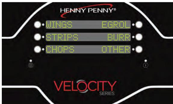
A opção 6 ITEM (6 ITENS) permite ao utilizador controlar os seis itens no menu de confeção. Se existir mais do que um menu de confeção, o utilizador deve programar as ligações de navegação noutros menus.
