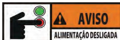
Para evitar queimaduras provocadas pelos salpicos do óleo, o interruptor de alimentação principal da unidade deve ser colocado na posição Desligado antes reiniciar o dispositivo de proteção de reinício manual do motor da bomba do filtro.
