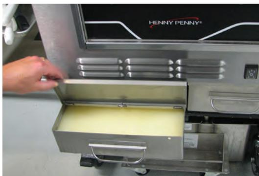
O recipiente do óleo novo introduz automaticamente óleo na cuba de fritura quando verifica que o nível do óleo é reduzido. O utilizador deve adicionar óleo novo ao recipiente, conforme necessário. NÃO adicione óleo novo diretamente na cuba de fritura.
