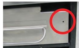
A condensação excessiva da cuba é drenada para o recipiente de condensação. O recipiente está equipado com um orifício de drenagem de modo a indicar que o recipiente está cheio e que necessita de ser esvaziado.
