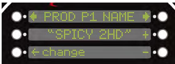
Pour supprimer toute lettre ou tout chiffre pouvant rester après un remplacement ou saisi accidentellement, presser les boutons de flèche jusqu'à atteindre la lettre ou le numéro à supprimer. En utilisant les boutons + ou -, faire défiler les lettres jusqu'à afficher un blanc.
