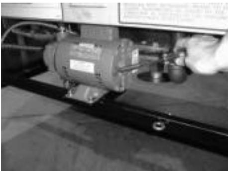
Si le moteur de la pompe de filtre ne fonctionne plus, appuyez sur le bouton de réenclenchement manuel qui se trouve sur l'arrière du moteur. Attendez environ 5 minutes avant d'essayer de réenclencher ce dispositif de protection.
