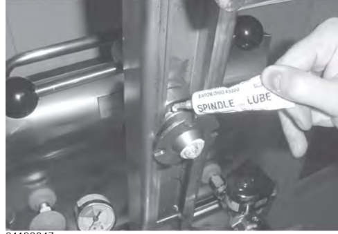
Şekil 3-36 Mil Dişlerini Yağlama
