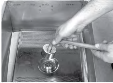
Şekil 3-21 Emiş Denge Borusunu Sökme
