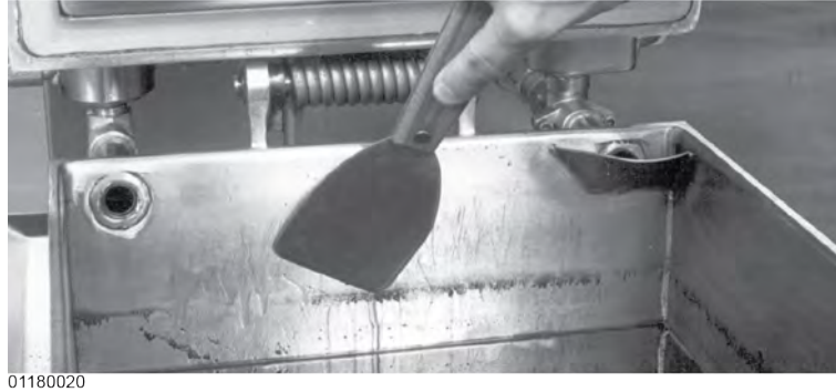
Şekil 3-11 Kızartma Teknesi Duvarlarını Kazıma
