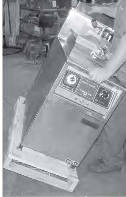
Şekil 2-2 Fritözü Yan Yatırma
