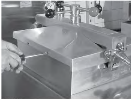
Şekil 3-30 Kapak Astarı Vidalarını Geri Çekme
