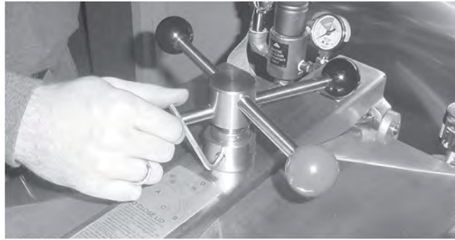
Şekil 3-37 Dış Manşon Tespit Vidalarını Gevşetme
