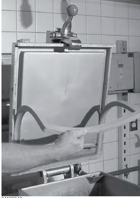
Şekil 3-31 Contayı Dışarı Çıkarma
