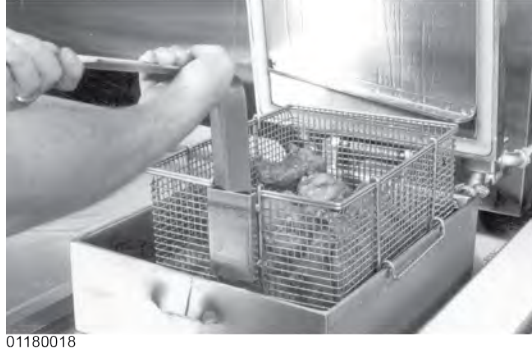
Şekil 3-9 Kızartma Teknesinden Ürünü Çıkarma
