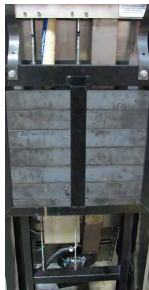
Ansicht der Gegengewichte bei abgenommener Abdeckung
