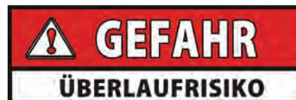
**STELLEN SIE SICHER, DASS DAS FETT NIE HÖHER ALS DIE OBERE FÜLLSTANDSLINIE DER FRITTIERWANNE IST. EIN NICHTBEACHTEN DIESER ANWEISUNGEN KANN ZU EINEM ÜBERFLIESSEN VON FETT AUS DER FRITTIERWANNE FÜHREN UND SCHWERE VERBRENNUNGEN, VERLETZUNGEN, BRÄNDE UND/ODER MATERIALSCHÄDEN ZUR FOLGE HABEN.**
