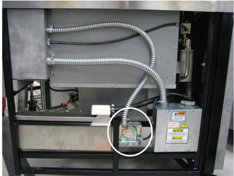
Entfernen Sie das rechte Seitenpaneel, um auf die Verteilerdose zugreifen zu können, und folgen Sie den entsprechenden Schaltdiagrammen unten.
