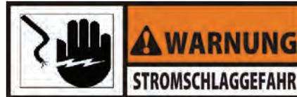
Diese Frittiermaschine muss ordnungsgemäß und sicher geerdet werden, um eine Stromschlaggefahr zu vermeiden. Informationen für die korrekten Erdungsverfahren finden Sie in den örtlichen Elektrovorschriften oder falls solche örtlichen Elektrovorschriften nicht existieren in 'The National Electrical Code, ANSI/NFPA Nr. 70 (die aktuell gültige Version). In Kanada müssen alle Elektroanschlüsse gemäß CSA C22.1, Canadian Electrical Code Part 1, und/oder den örtlichen Vorschriften ausgeführt werden.
