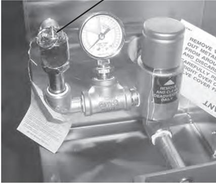
**Reinigen des Sicherheitsventils - Jährlich**
