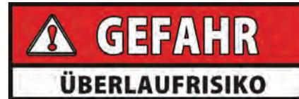
**DIE ROSTE DÜRFEN NICHT ÜBERFÜLLT WERDEN UND ES DÜRFEN KEINE PRODUKTE MIT EINEM SEHR HOHEM FEUCHTIGKEITSGEHALT HINEINGLEGT WERDEN. 9,5 KG (21 LBS) IST DIE MAXIMALE PRODUKTMENGE PRO FRITIERWANNE. WENN DIESE ANWEISUNGEN NICHT BEFOLGT WERDEN, KANN DAS FETT AUS DER FRITIERWANNE ÜBERLAUFEN UND SCHWERE VERBRENNUNGEN, VERLETZUNGEN, BRÄNDE UND/ODER SACHSCHÄDEN VERURSACHEN.**
