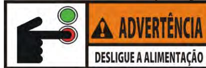
**Para evitar queimaduras provocadas pelos salpicos da gordura de fritar, o interruptor de alimentação principal da unidade deve ser colocado na posição Desligado antes reiniciar o dispositivo de proteção de reinício manual do motor da bomba do filtro.**
