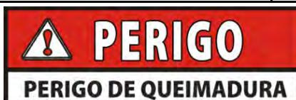
**NÃO OPERE A UNIDADE SE O INDICADOR DE PRESSÃO MOSTRAR CONDIÇÕES DE PRESSÃO ELEVADA. RESULTARÁ EM LESÕES E QUEIMADURAS GRAVES. COLOQUE IMEDIATAMENTE O INTERRUPTOR COOK/PUMP (FRITAR/BOMBEAR) NA POSIÇÃO DESLIGADA, QUE LIBERTA A PRESSÃO PERMITINDO QUE A UNIDADE ARREFEÇA. NÃO RETOME A UTILIZAÇÃO DA UNIDADE ATÉ A CAUSA DA PRESSÃO ELEVADA SER ENCONTRADA E CORRIGIDA.**
