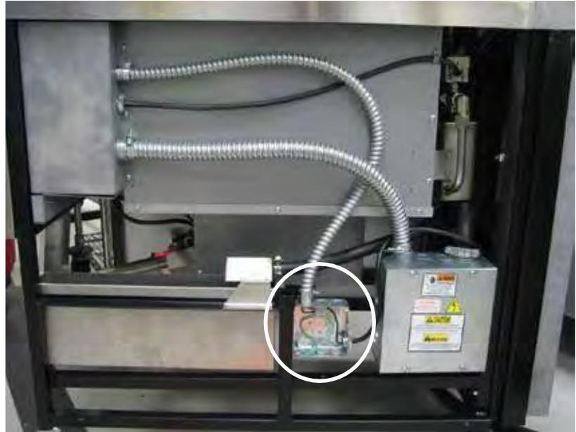
Remova o painel do lado direito para aceder à caixa de junção e siga os diagramas de cablagem apropriados abaixo.
