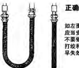
如左图所示，所有接头和管子应当安装在同一平面内。接头不要错位——否则会导致扭转打绞和应力过大，从而导致过早失效。
