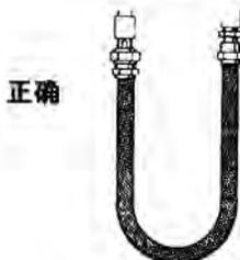
在接头之间保持最小或更大的弯曲直径，确保使用寿命最长。
