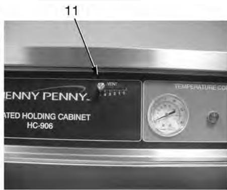
Вентиляционная система контролирует уровень влажности воздуха внутри шкафа, см. раздел «Устройства и компоненты системы управления» настоящего руководства. Регулировка вентиляции выполняется достаточно легко.
