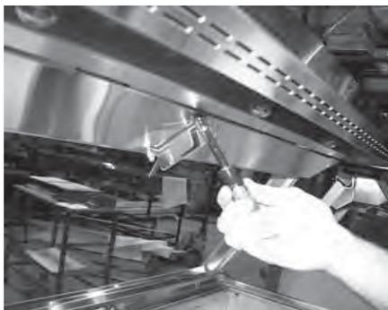
2. Usando uma chave de caixa de 3/8 de polegada ou uma chave de porcas eléctrica, desaperte as duas porcas de mama que seguram o suporte, mas não as retire.
