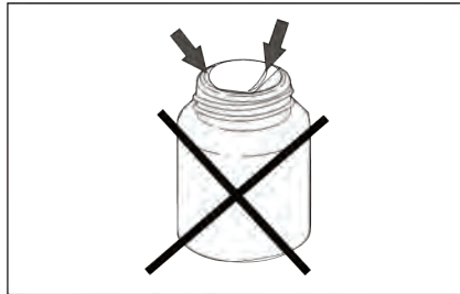
Sigillo sulla cartuccia danneggiato
