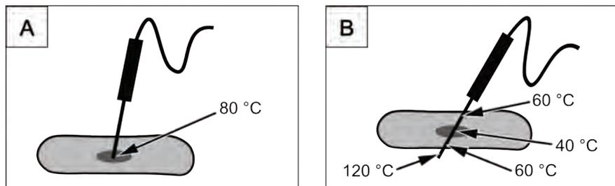
*Sensore di temperatura interno a uno e a quattro punti di misurazione*
