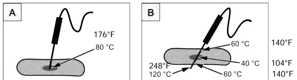
Misurazione della temperatura interna con un sensore di temperatura interno a 1 o 4 punti
