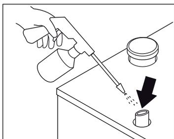
1. Vérifier si les tubulures d'échappement de vapeur et les conduites raccordées présentent des dépôts.
