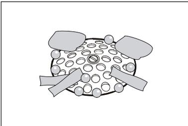
1. Retirer de l'enceinte du four les restes des aliments à cuire. Le filtre d'écoulement doit être libre.
