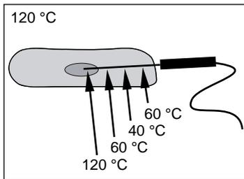
La sonde mesure la température à cœur en quatre points, le point de mesure le plus froid est utilisé pour la commande de la cuisson. La pointe de la sonde de mesure ne doit donc pas obligatoirement se trouver au centre des aliments.
