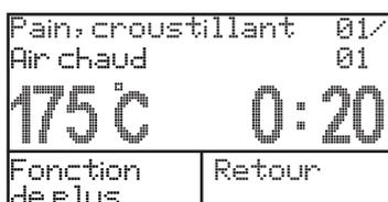
4. A l'aide du commutateur CombiDial (9), régler la température et le temps.
