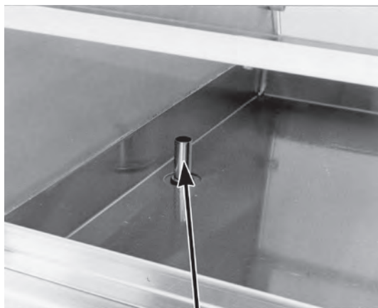
Напорна тръба на дренажния канал
