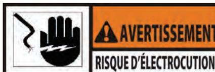
**Pour éviter tout risque de choc électrique, cet appareil doit être équipé d'un disjoncteur externe qui déconnectera tous les conducteurs sans fil de masse. L'interrupteur d'alimentation principal sur cet appareil ne permet pas de déconnecter tous les câbles conducteurs**
