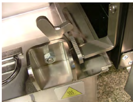
Figure 3-30 Фиксатор сливного поддона поднят
