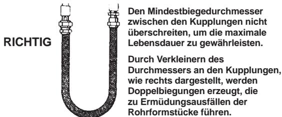
Den Mindestbiegedurchmesser zwischen den Kupplungen nicht überschreiten, um die maximale Lebensdauer zu gewährleisten. Durch Verkleinern des Durchmessers an den Kupplungen, wie rechts dargestellt, werden Doppelbiegungen erzeugt, die zu Ermüdungsausfällen der Rohrformstücke führen.
