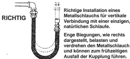
Richtige Installation eines Metallschlauchs für vertikale Verbindung mit einer einzigen, natürlichen Schlaufe. Enge Biegungen, wie rechts dargestellt, belasten und verdrehen den Metallschlauch und können zum frühzeitigen Ausfall der Kupplung führen.
