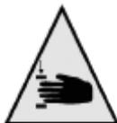
Symbol für Quetschgefahr (Friteusen mit automatischer Hubfunktion)
