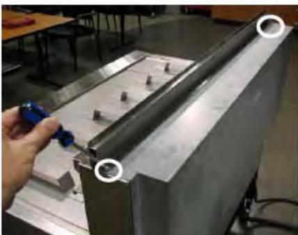
Сдвиньте панель, чтобы она совпала с вытяжным зонтом, и затяните 3 гайки.
