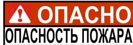
**ПРИ ПРОДОЛЖИТЕЛЬНОМ ИСПОЛЬЗОВАНИИ ТЕМПЕРАТУРА ВОЗГОРАНИЯ МАСЛА СНИЖАЕТСЯ. ПРИ ПОЯВЛЕНИИ ПРИЗНАКОВ ОБРАЗОВАНИЯ ИЗЛИШНЕЙ ЗАДЫМЛЕННОСТИ И ВСПЕНИВАНИЯ ВЫБРОСЬТЕ МАСЛО. В ПРОТИВНОМ СЛУЧАЕ ВОЗМОЖНЫ СИЛЬНЫЕ ОЖОГИ, ТРАВМЫ, ПОЖАР И/ИЛИ ПОЛОМКА ОБОРУДОВАНИЯ.**
