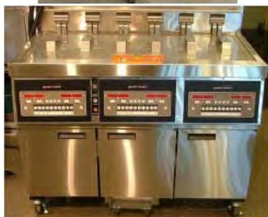
Для правильной эксплуатации аппарат должен быть установлен по уровню в двух направлениях: от одной боковой стенки к другой и от фронтальной поверхности к задней стенке. Используя уровень, расположив его на плоскую поверхность на средней кромке, отрегулируйте ролики до достижения уровня.
