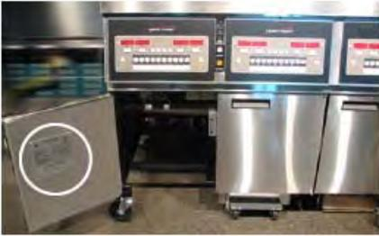
На табличке с техническими параметрами, находящейся на левой дверце аппарата, приведены правильные параметры для подключения к электросети.
