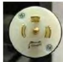
Второй силовой кабель обеспечивает подвод электроэнергии к системе нагрева и для подключения используется вилка типа NEMA 15-60P. Каждая ванна подключается через отдельный силовой кабель.
