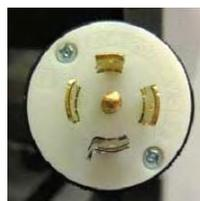
L'altro cordone di alimentazione, che eroga la corrente per il circuito di riscaldamento, ha una spina diritta NEMA 15-60P; ciascuna vasca impiega un proprio cordone di alimentazione.
