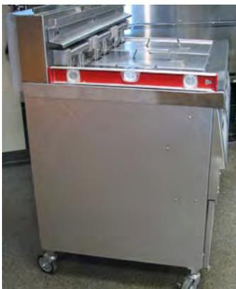
Pour fonctionner correctement, la friteuse doit être à niveau dans les sens transversal et longitudinal. Vérifier que c'est le cas à l'aide d'un niveau placé sur les parties plates entourant la rehausse du bac, puis régler les roulettes jusqu'à ce que l'appareil soit à niveau.
