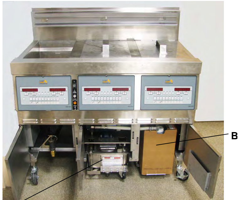
A. Bandeja de drenaje, B. garrafa JIB (garrafa en el interior de la caja)
