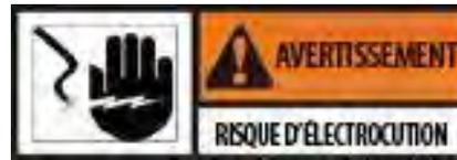
Cette friteuse doit impérativement être mise à la terre (masse) pour prévenir tout risque d'électrocution. Consultez les codes électriques locaux pour connaître les procédures de mise à la terre (masse) appropriée ou en l'absence de codes locaux, conformez-vous au Code national de l'électricité, ANSI/NFPA N° 70 (l'édition actuelle). Au Canada, tous les branchements électriques doivent se faire conformément au CSA C22.1, du Code canadien de l'électricité, partie 1 et/ou aux autres codes locaux.
