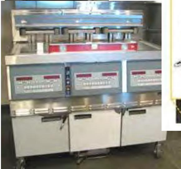
Pour assurer un fonctionnement correct, la friteuse ouverte doit être de niveau, d'un côté à l'autre et d'avant en arrière. À l'aide d'un niveau placé sur les zones plates autour du collier du bac, sur la cavité du milieu, ajustez les roulettes jusqu'à ce que l'appareil soit à niveau. Les roulettes sont ajustables jusqu'à 1,562 po (40 mm)...voir ci-dessous.
