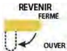
Indique la direction dans laquelle tourner la poignée jaune pour ouvrir la vanne de remplissage pour pomper de l'huile dans le bac
