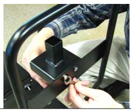
FIXER LE SUPPORT À LA POIGNÉE AVEC LES BOULONS FOURNIS ET FAIRE GLISSER L'ENSEMBLE POMPE/TUBES PAR LE TUBE CARRÉ DANS LE TUBE ROND.
