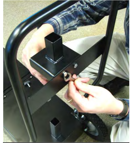
用提供的螺栓将固定夹拧紧到横杆上，将油泵和油管组件经由方形管进园管。
