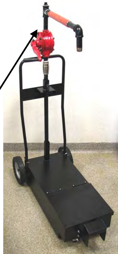
取黑色管道组件，用特氟纶带将黑色组件固定到油泵的顶部，如图所示。一直转动，直到拧紧至如图所示方向。
