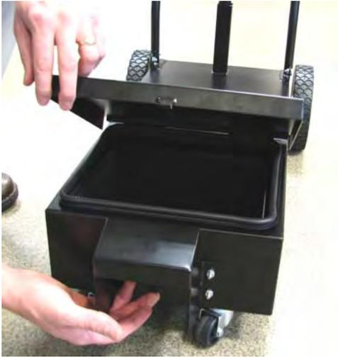
1. Desapertar a mola da tampa e abrir a tampa sobre o tabuleiro. Verificar se o tabuleiro de migalhas se encontra instalado.
