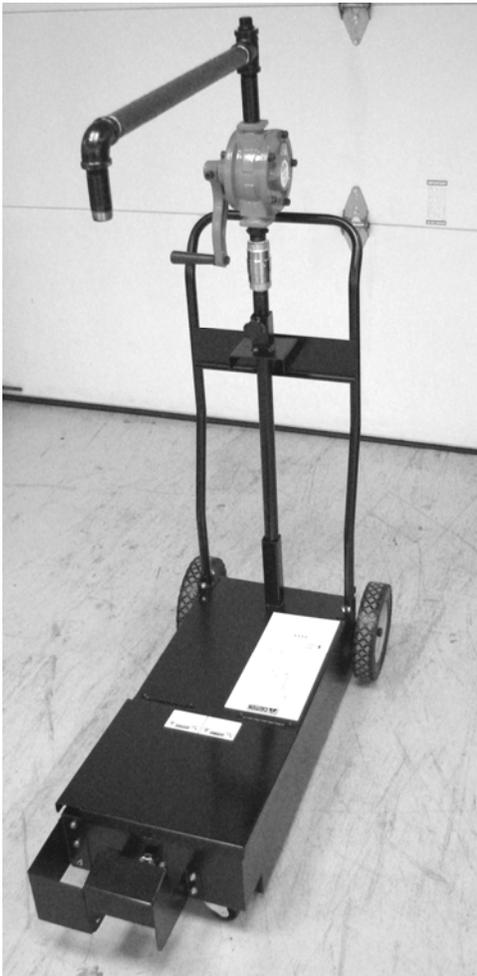
14. Após o esvaziamento do tabuleiro de descarte, desapertar o parafuso de fixação no suporte e rodar novamente a bomba sobre a unidade inferior; apertar o manípulo.
