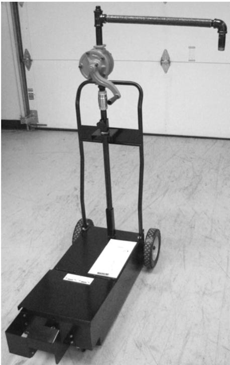
13. Rodar rapidamente o manípulo da bomba de modo a ferrar a bomba e permitir a circulação do óleo na bomba.
