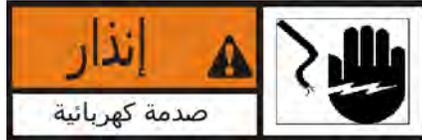
يجب أن يتم تأريض الجهاز بشكل كافٍ آمن. يرجى الإشارة إلى الرموز الكهربائية المحلية لاتباع إجراءات التأريض الصحيحة. إذا لم يتم تأريض الجهاز بشكل صحيح، فقد ينتج عن ذلك حدوث صدمة كهربائية.
