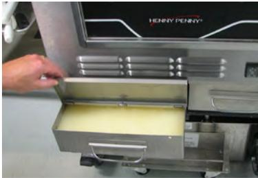
24. Retirer le conteneur en dessous de la friteuse et mettre au rebut.
