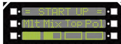
Durant chaque étape, la barre de progression se remplira jusqu'à achèvement. La durée de chaque étape dépend de la température de l'huile lors du démarrage initial et des points de consigne en place sur l'appareil.
