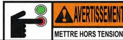
**Pour éviter toute brûlure causée par des éclaboussures d'huile, tourner le commutateur d'alimentation en position d'arrêt avant de réinitialiser le dispositif de protection de réinitialisation manuelle du moteur de la pompe de filtrage.**
