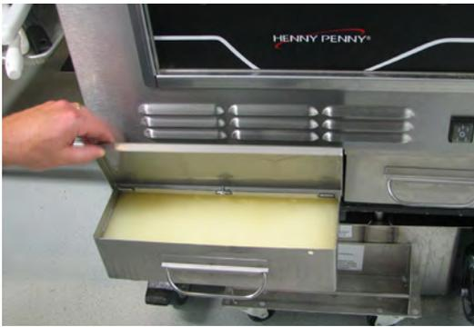
Le réservoir d'huile fraîche remplit automatiquement en huile le bac de friture lorsqu'il détecte que le niveau d'huile est bas. L'utilisateur doit ajouter de l'huile fraîche dans le réservoir lorsque requis. NE PAS ajouter d'huile fraîche directement dans le bac de friture.
