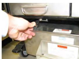
1. Glisser une enveloppe-papier filtre sur le tamis de façon à ce que la prise sorte de l'orifice.
