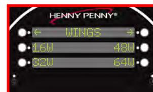
Presser le bouton à côté de l’élément que vous voulez cuisiner démarre le processus de chauffage. « DROP » (abaisser) s’affiche lorsque l’appareil est prêt à cuire l’élément sélectionné.
