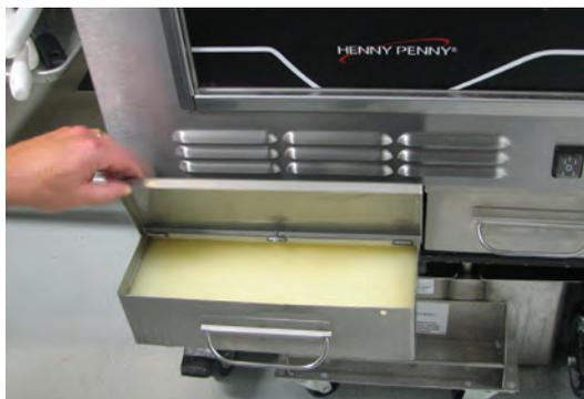
Il serbatoio di olio fresco si rabbocca automaticamente al massimo quando la vasca di frittura rileva che il livello dell'olio è basso. L'utente deve aggiungere olio fresco al serbatoio come necessario. NON aggiungere olio fresco direttamente alla vasca di frittura.
