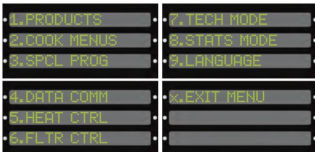
In questa sezione viene illustrato come accedere al menu di programmazione ("PROG") per l'accesso al programma prodotti, cottura e speciale.
