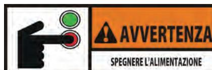
**Per prevenire scottature causate da spruzzi d'olio, portare l'interruttore di alimentazione dell'unità in posizione OFF prima di reimpostare il dispositivo di protezione di ripristino manuale del motore della pompa.**
